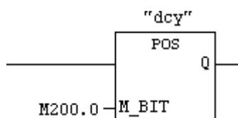
La sortie Q est à 1 au front montant de DCY.
